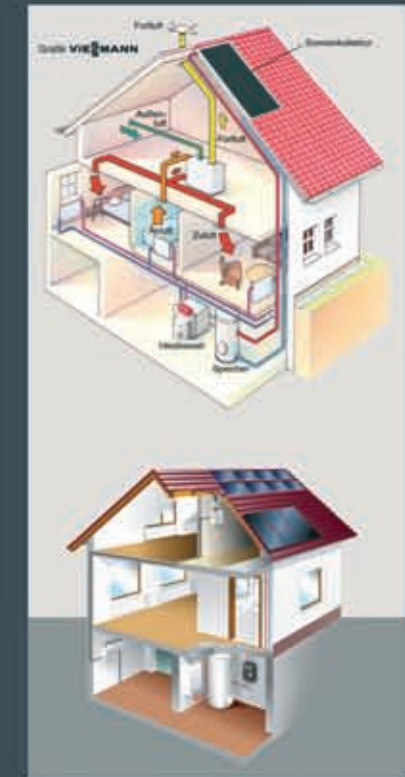
Kontrollierte Wohnraumlüftung und solare Energieerzeugung im Einfamilienhaus.
