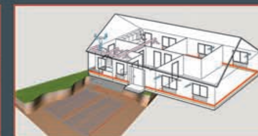
Wärme und Kühlung durch Erdwärme Flächenkollektor einer Sole/Wasser-Wärmepumpe
